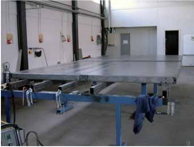
Kuvat 2 ja 3. Laserhitsattu, metallikennosta valmistettu autohissin lattia.
